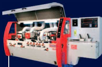
moldurera enderezadora de 9 a 60 mt/min modelo SUPERTECH
